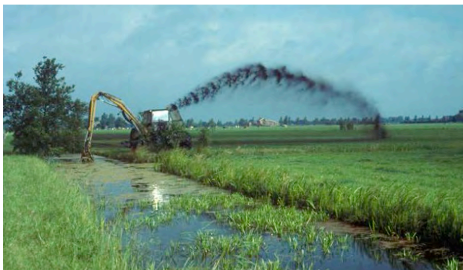
Figuur 6: Werking van de baggerpomp geplaatst aan een tractor (bron: © Theo de Jong).
